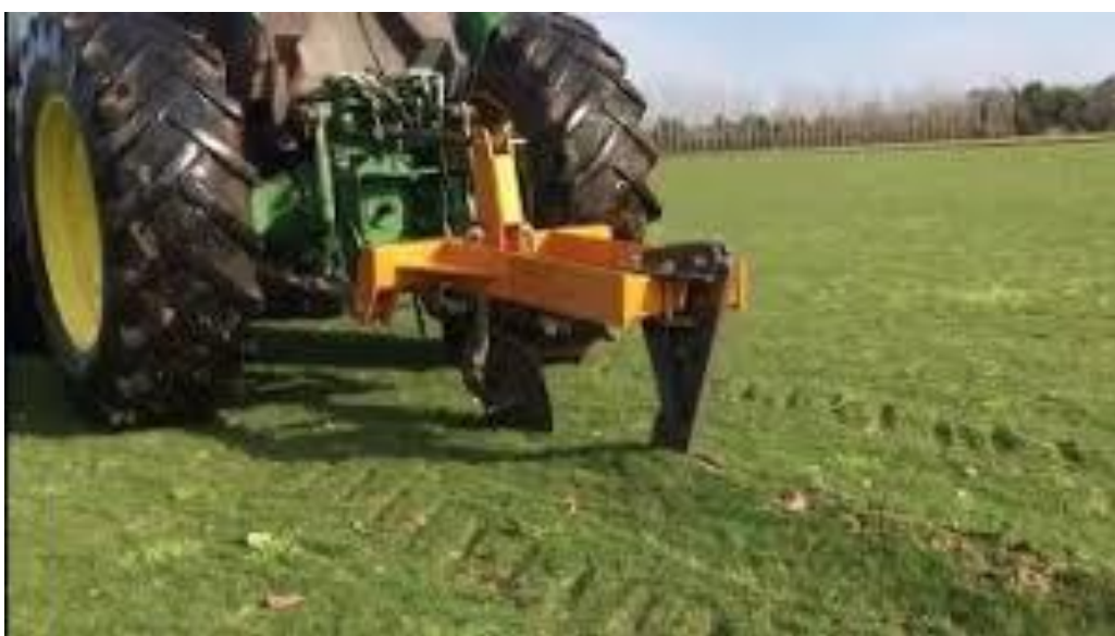
Ilustración 13. Tractor agrícola executando un subsolado simple. Fonte: Maquinarias Ibarrola.
